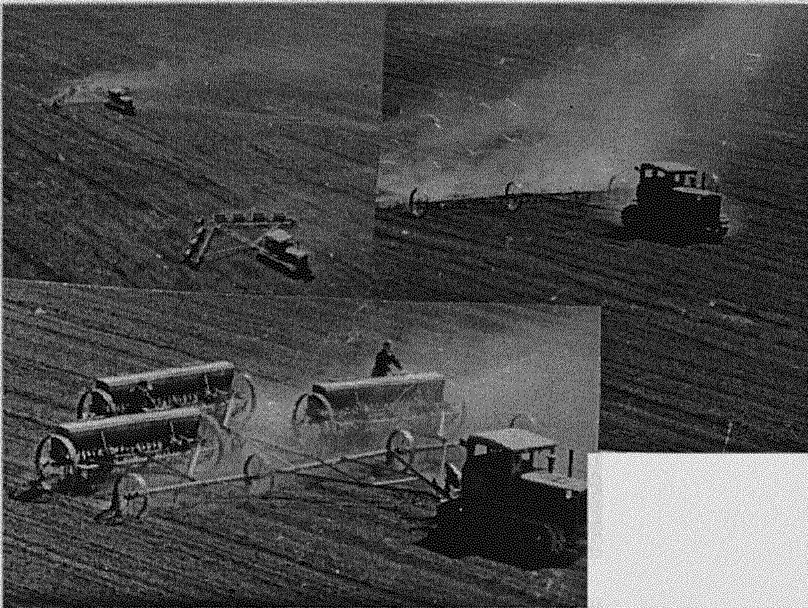
Дисковые лушильники, зубовые бороны и сеялки распыляют почву до эрозионно-опасного порога
