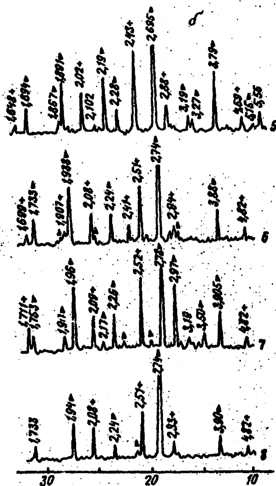
Рисунок 2. Рентгенограммы спеков шпинельных соединений б – с MgCr_2O_4 ; 7 – MgFe_2O_4 ; 8 – хромшпинелид рудный. Обозначения ( \downarrow ) – Y_3Al_2O_6 ; ( \Delta ) – La(Al, Cr, Fe)O_3 ; 30% Y_2O_3 ; б – La_2O_3 ( T=1650^\circ C ) 1,5 – MgAl_2O_4 ; 2,6 – фаз: (+) – шпинели; (o) – Y_2O_3 ; (o) – Y(Al, Cr, Fe)O_3 ;
