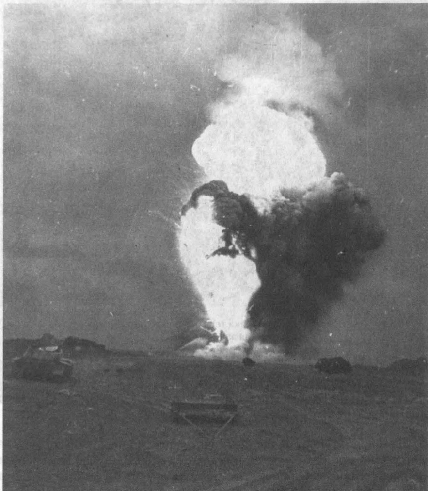
Фото 3.5. Взрыв заряда помещенного в шурф
