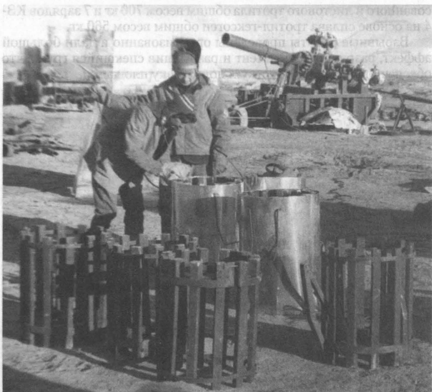
Фото 3.6. Подготовка термостойкого контейнера для заряда КЗ-4
