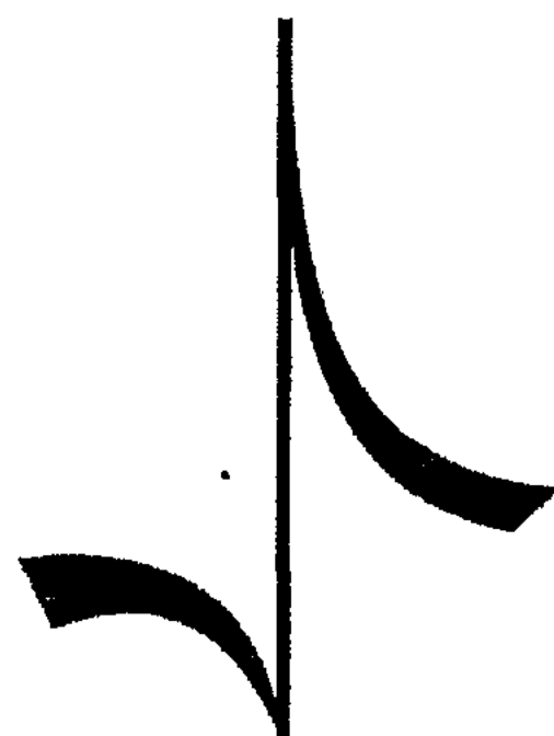
Рис. 1. Электронный парамагнитный резонанс в образцах нефти Бавлинского месторождения (Татарстан). Одиночная линия обусловлена свободным радикалом ( R\cdot ) асфальтеновой структуры
