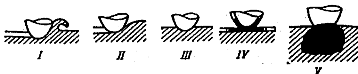
Рисунок 2. Схема фракционных контактов (по И.В. Крагельскому)
