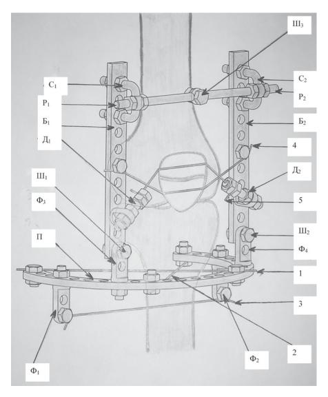
Рисунок 1-Устройство для остеосинтеза переломов надколенника
