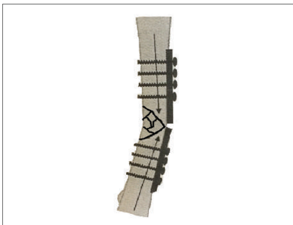
Рисунок 1 а - Схема перелома пластины в месте наибольшей концентрации напряжений
