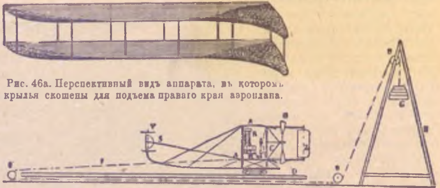
Рис. 47. Схема прибора для взлета аэроплана Райта.
