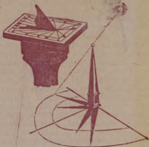
Обыкновенные солнечные часы и принципъ ихъ дѣйствія.
