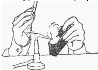
111 -сурет. данекер түтiк пен пайдаланып затты тотықсыздандыру.
