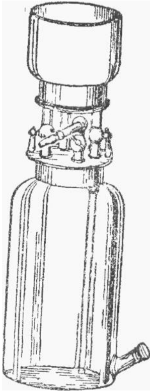
32 сурет. Тініке ғазыметір. II. Шыны ғазыметір
