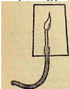
28-сұурет. Сұу тегінің жалынының үстіне төңкерілген ыстақан.
