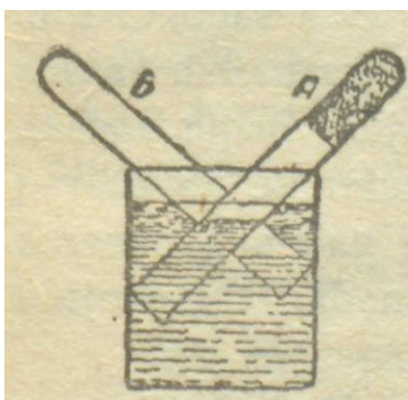
25-сурет. Мысты қыздырғанда әуенің біразымен қосылатынын көрсететін аспап
