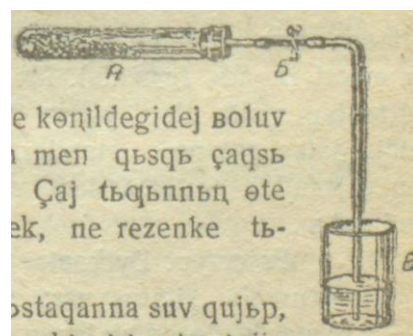
26-сурет. Темірді тот басқанда әуенің біразы мен темірдің қосылатыны көрсетілген
