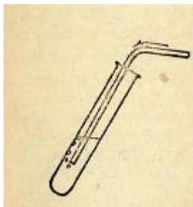
8-сурет. Иштен шығатын ауаны, ізбесіт сұуынан өткізуу.
