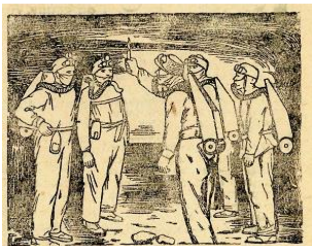
52—сурет. От тегі толтырылған болат селендір мен қамтамасыздандырылған кен үңгірлерінде сақтаушы әтіреттер. Арқаларына таңылған селендірлердегі от тегі сақтық құрап ішіндегі ірзенке қарсығына барып, одан тұрба арқылы бетке кійген жарты маскіге барады.
