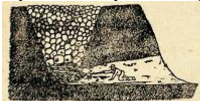
12-сұурет. Ізбес өртейтін реш (жарма) ізбестнйк тайдың бауырынан жасаған шұқырға салынады, астынан от қойылады.
